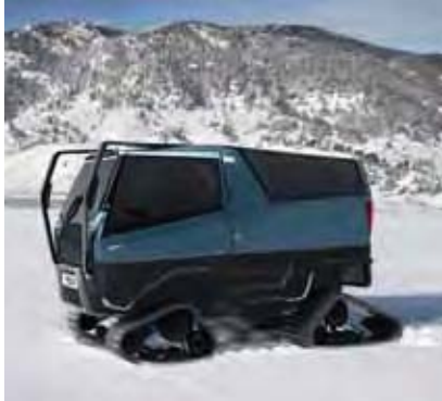
HYCAT Hybrides Geländetransportfahrzeug
