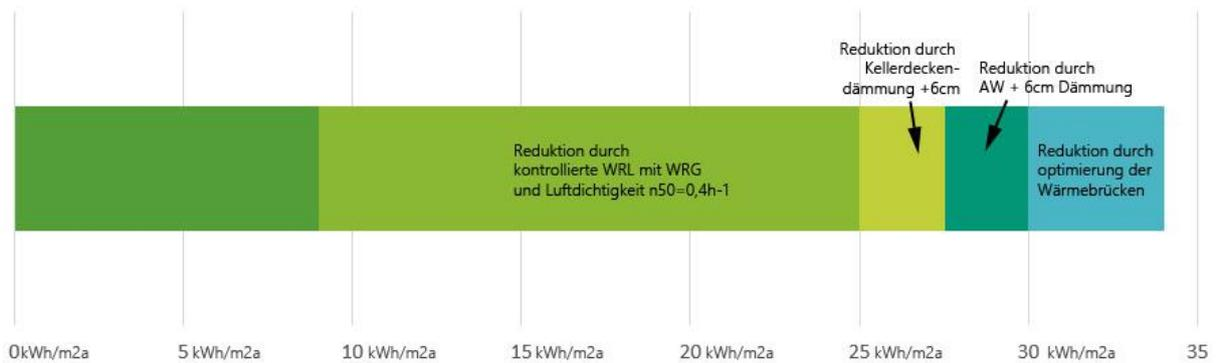
Abbildung 19: Ergebnisse für Einzelmaßnahmen in Kombination: Heizwärmebedarf Musterhaus Ehrenreich - Referenzklima, OIB 2011 (© FH Salzburg – Smart Building – Tobias Weiß)
