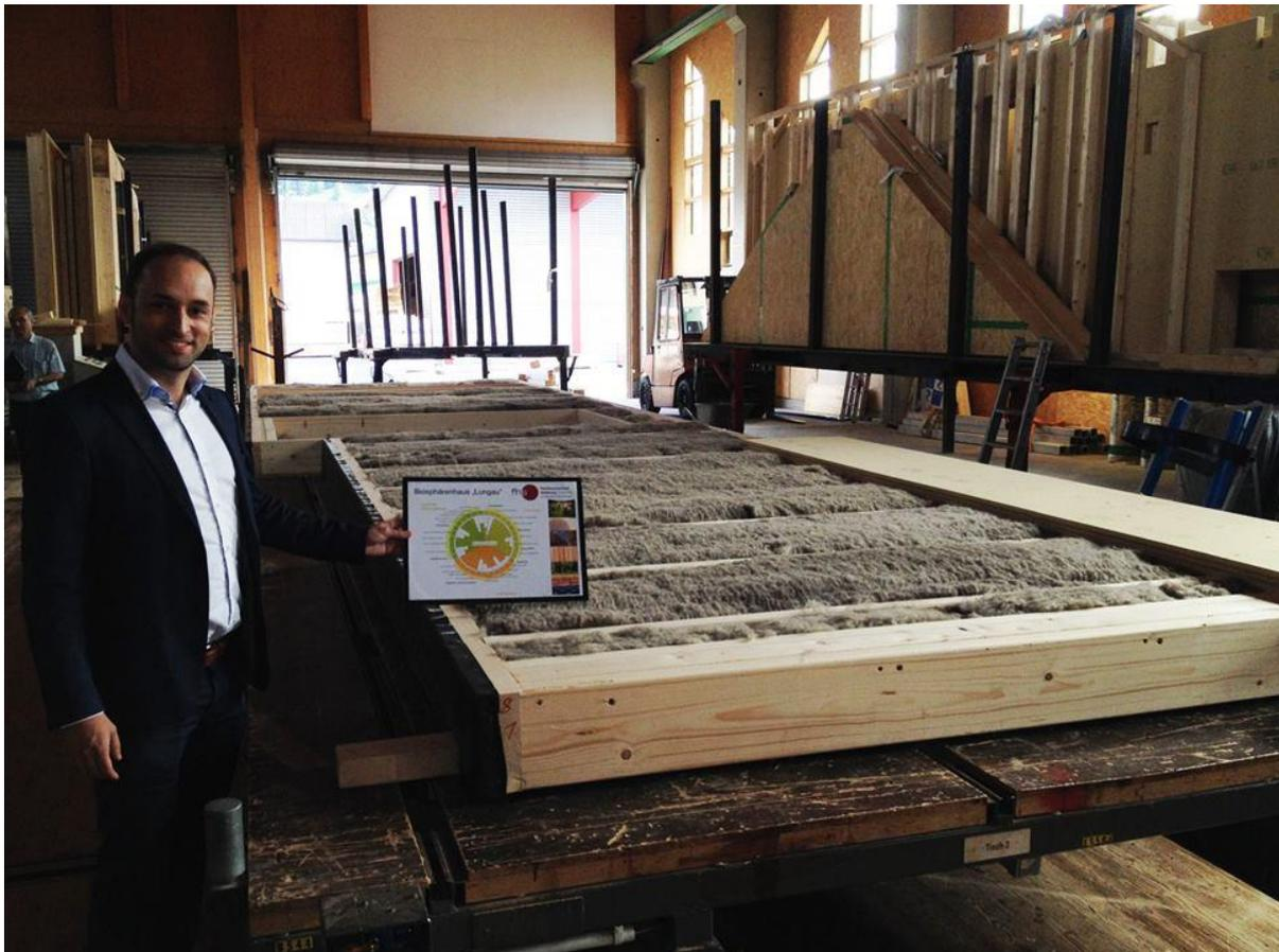
Abbildung 13: Fertigteil – Prototyp mit Schafwolldämmung der Firma Ehrenreich in Tamsweg (Foto: Tobias Weiß)
