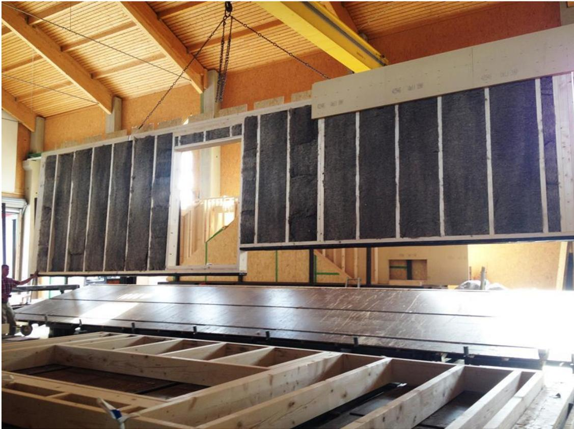
Abbildung 14: Fertigteil – Prototyp mit Schafwolldämmung der Firma Ehrenreich in Tamsweg (Foto: Tobias Weiß)
