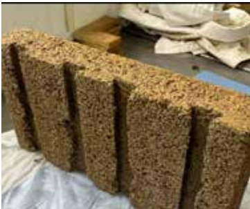
Test der Wasseraufnahme nach einer mehrwöchigen Lagerung in einer Salzlösung.
