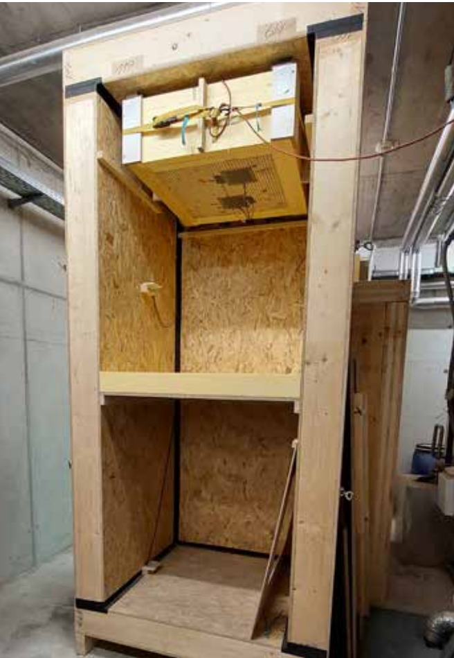
Entwicklung und Umsetzung einer experimentellen Prüfkammer für die Ermittlung des Wärmeübergangs an der Grenzschicht Holz und Luft.
