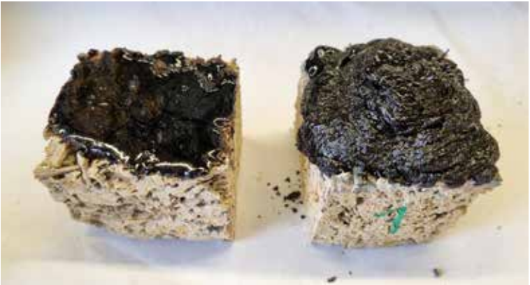
Vergleich zwischen nicht-expandierendem und expandierendem 2K Tanninklebstoff.
