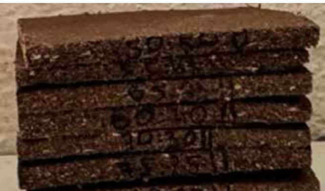
Beispiel für die hergestellten Composite aus Holzfasern und Kaffeesatz für mechanische Prüfungen.
