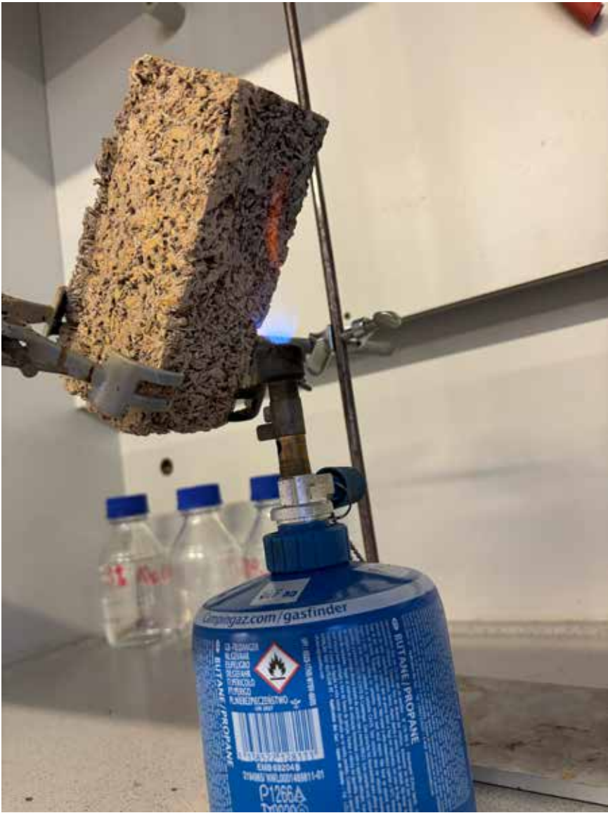
Brandversuch (Small Flame Test) eines HSB-Prüfkörpers für 30 Minuten
