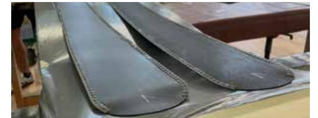
Präziser Zuschnitt der Form des mehrschichtig aufgebauten Rohlings.
