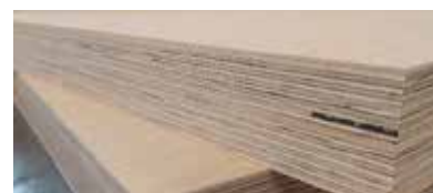
Furniersperrholzplatten mit Phasenwechselmaterial imprägniert zur Untersuchung der Bauteilaktivierung als thermischer Energiespeicher.
