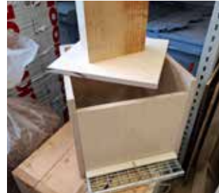
Pressform zur Entwässerung im Nassverfahren
