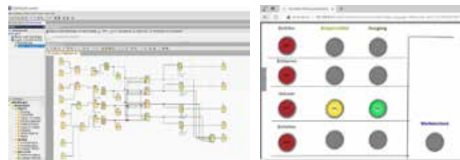
Umsetzung einer Steuerung mit Funktionsbausteinen und Anwendung in einem Web User Interface mit Siemens Logo.
