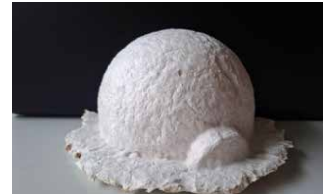
Myzelbasiertes Schwalbennest als Prototyp für nachhaltige, biobasierte Strukturmaterialien.
