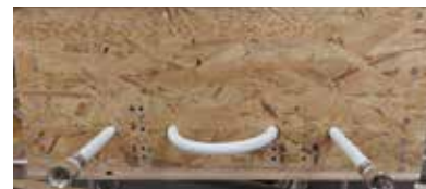
Prüfkörper mit eingebauten Wasserleitungen zur Untersuchung auf der Unterseite PCM-imprägnierter Platten.
