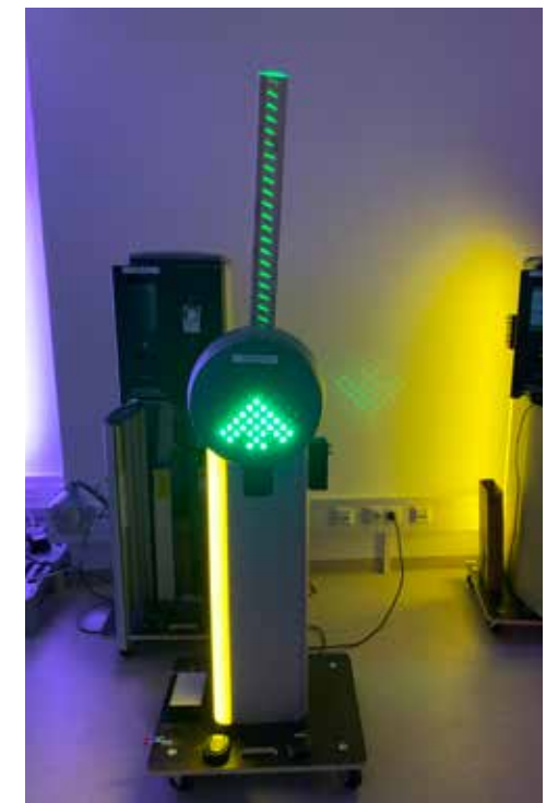
Prototyp des Schrankenbaums, der im Anschluss in einem Witterungstest auf seine Beständigkeit geprüft wurde.
