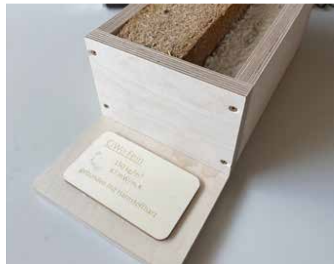
Realer Versuchsaufbau einer Dämmung mit Betonverguss.
