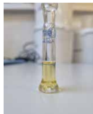
Dichtemessung von Biodieselproben
