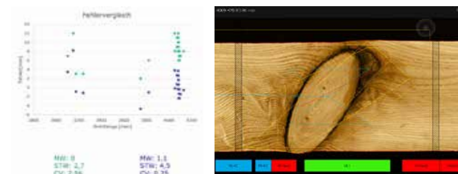
Datenerhebung als Basis zur Kalibrierung einer Scanninganlage.
