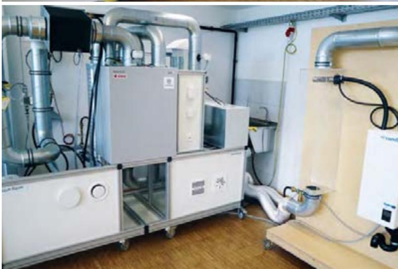
Laboranlage zur Konditionierung des Raumklimas
