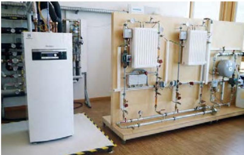
Neben einem Wärmepumpenprüfstand mit einer intelligenten Mess- und Leittechnik und einer Photovoltaikanlage am Dach mit integriertem Energiedaten-Monitoring-System stehen zudem auch Datenlogger zur Aufzeichnung von Temperatur, Luftfeuchtigkeit und CO<sub>2</sub>-Konzentration für Behaglichkeitsmessungen in Gebäuden zur Verfügung.
